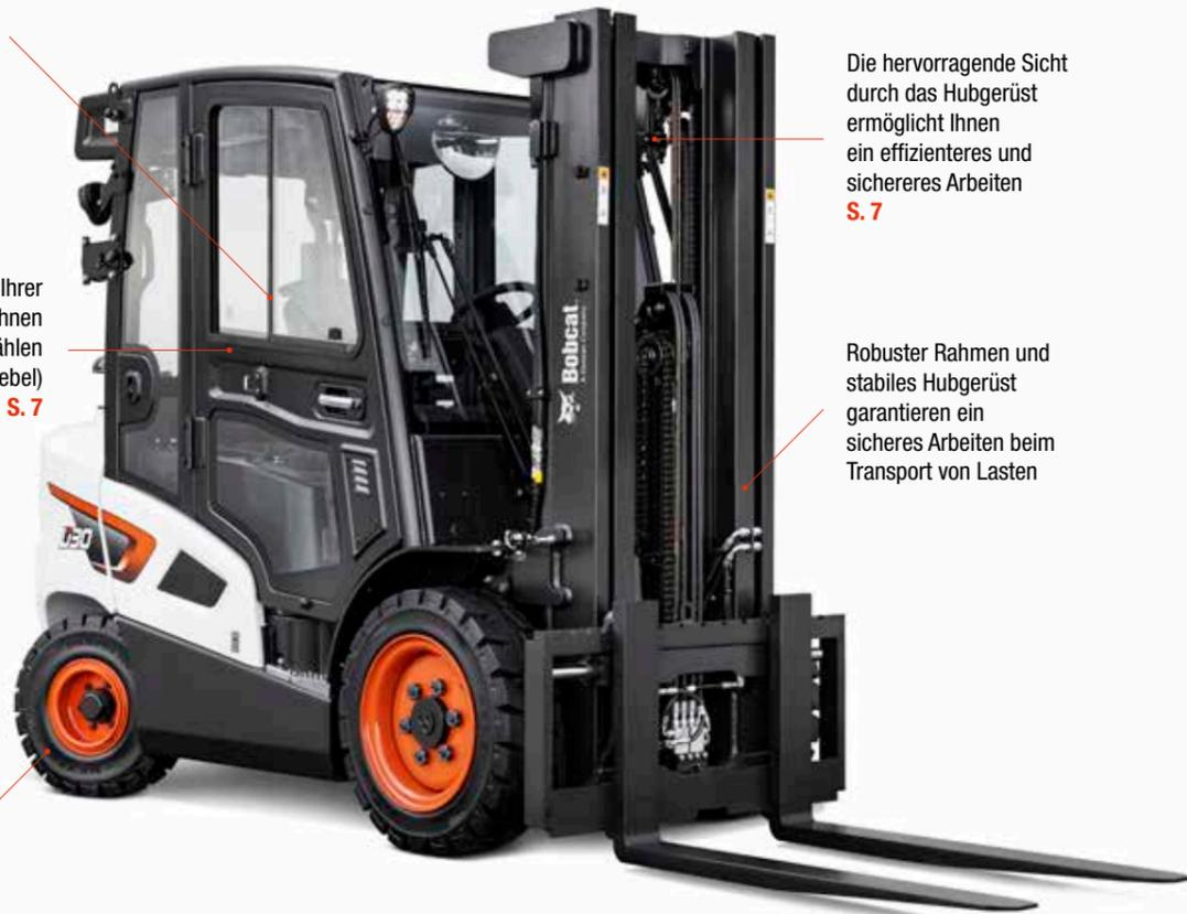
Schwimmende Kabine reduziert Lärm und Vibrationen für maximalen Komfort und Betriebszeit
