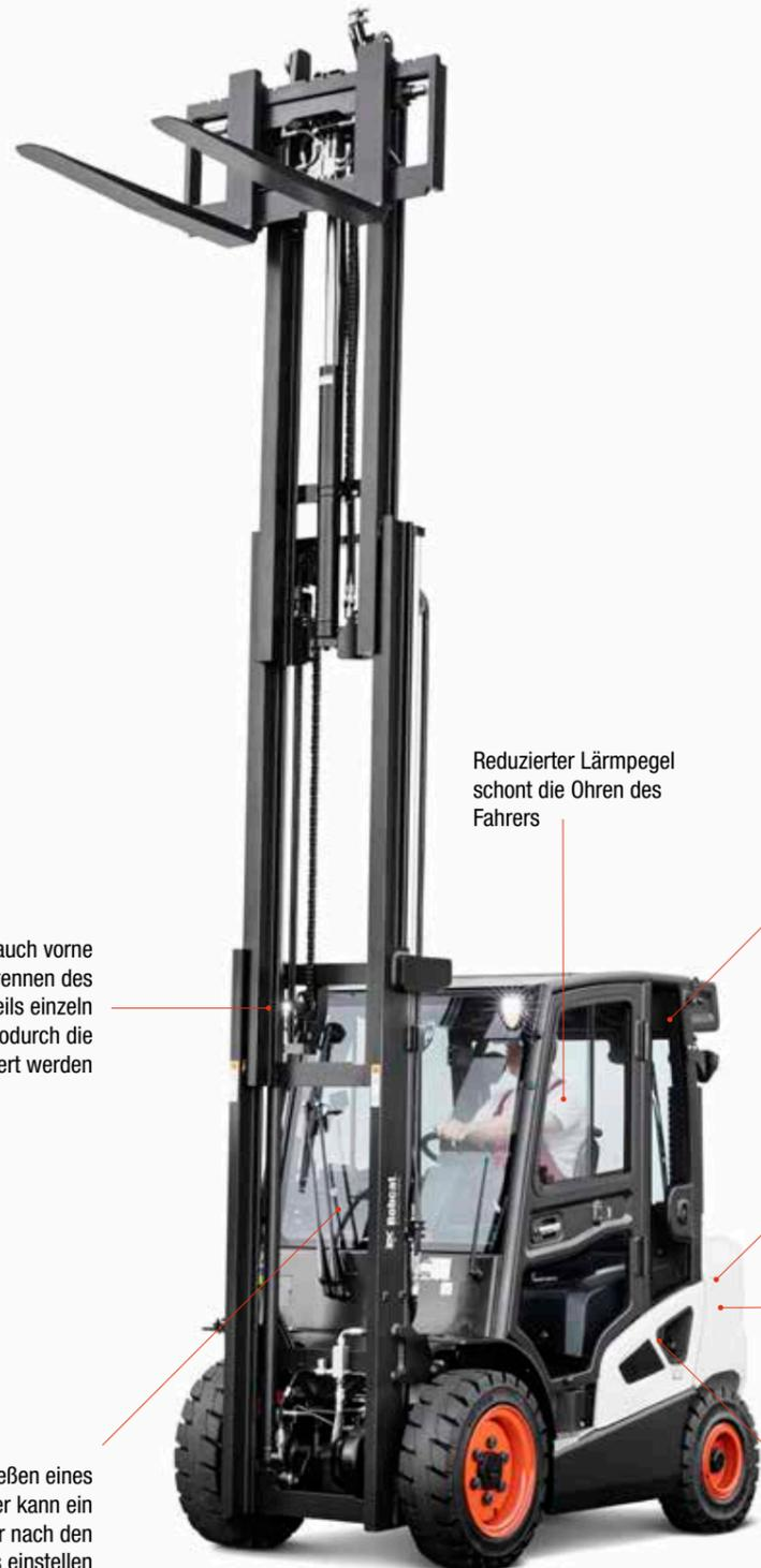
Der Hydraulikschlauch vorne kann durch Trennen des Primär-/Sekundärteils einzeln ausgetauscht werden, wodurch die Gesamtbetriebskosten reduziert werden
